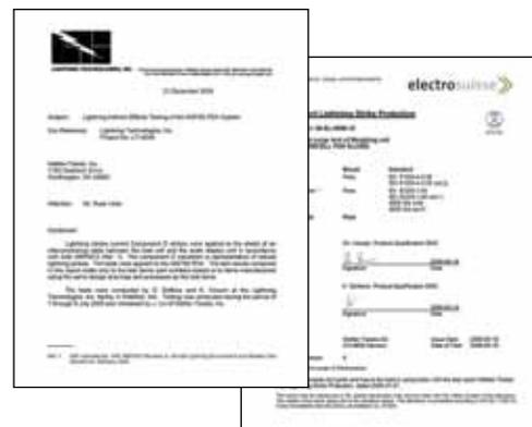
Le système de protection StrikeShield contre les foudroiements a été rigoureusement testé par des laboratoires indépendants : Lightning Technologies, Inc. et Elektro Swiss AG. Des tests utilisant les capteurs POWERCELL PDX ont démontré la résistance du système à des foudroiements de 80 000 ampères, ce qui correspond à plus de deux fois la puissance d'un foudroiement moyen (30 000 ampères).
